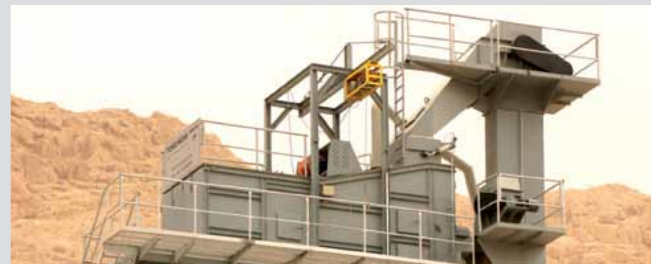
سردند و سیلوی ذخیره مصالح گرم Screens & hot bins
