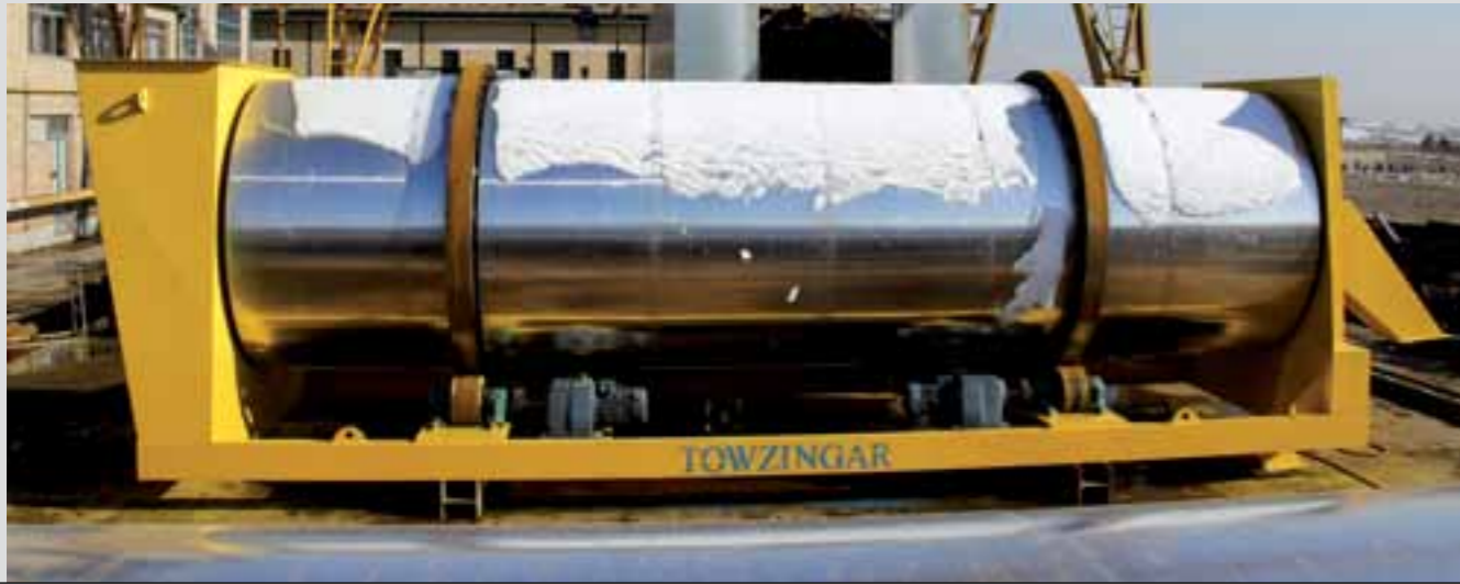
سیستم خشک کردن مصالح Drying system
